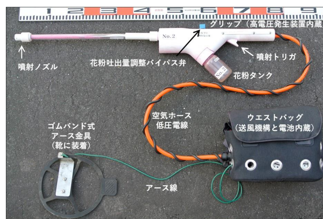
図1 静電風圧式受粉機（試作機）の概要※ ※実用化の際は構成を変更する可能性がある
