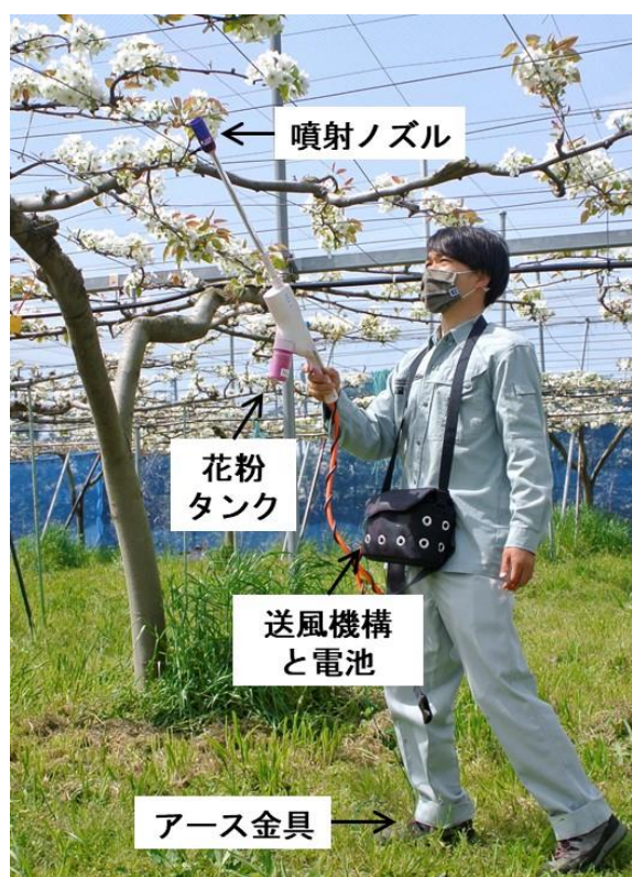
図2 静電風圧式受粉機の作業状況 （試作機、先端カバー付き仕様）
