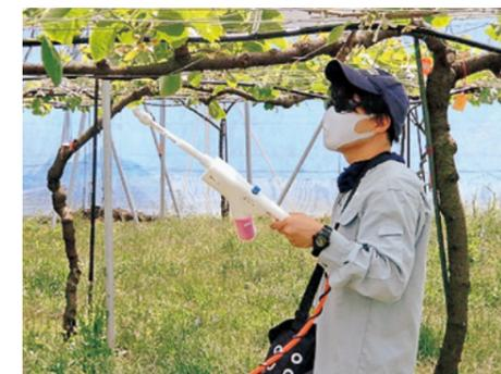
図1 試作機によるキウイフルーツの受粉作業(短ノズル仕様)
