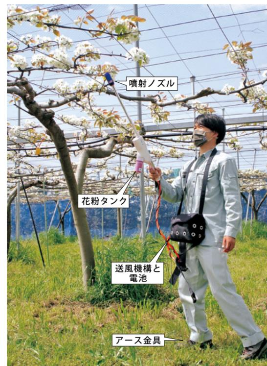
図2 静電風圧式受粉機の作業状況(試作機、ノズル先端カバー付き仕様)
