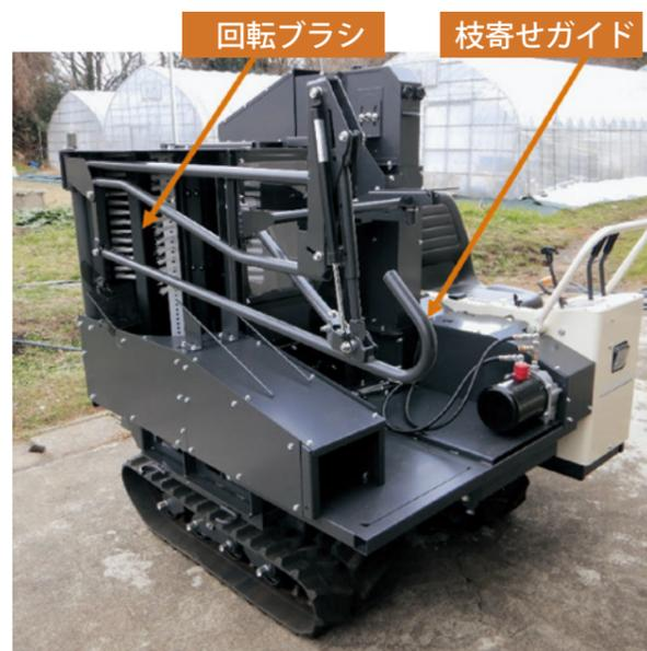
写真1 自走式花蕾採取機(試作機)の外観
