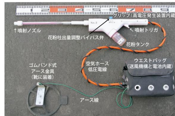
図1 静電風圧式受粉機(試作機)の概要
