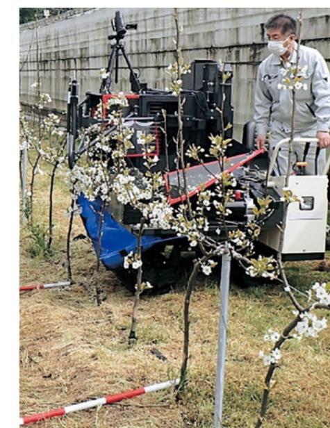
写真2 自走式花蕾採取機での試験状況
